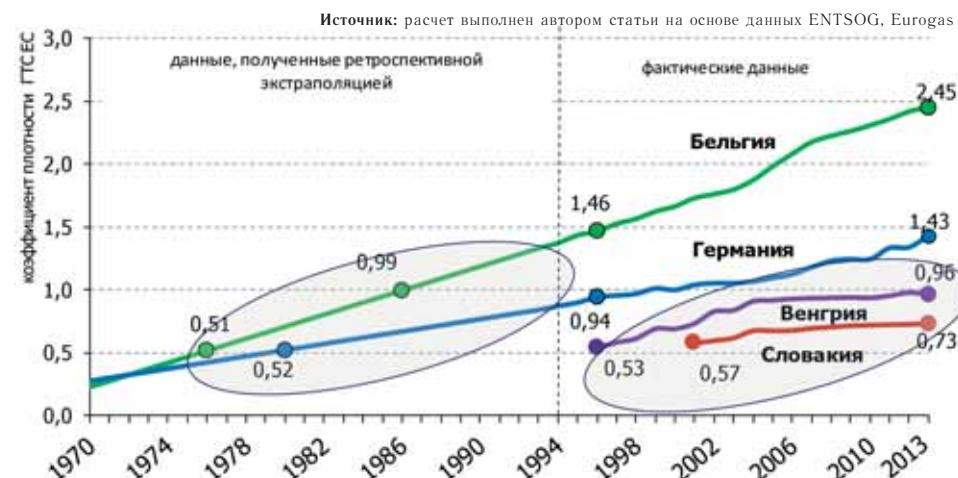
Рис. 4. Сопоставление плотности газотранспортной системы (магистральные и распределительные газопроводы): Бельгия и Германия (Северо-Западная Европа) vs Венгрия и Словакия (Центральная и Восточная Европа), км/км<sup>2</sup>
