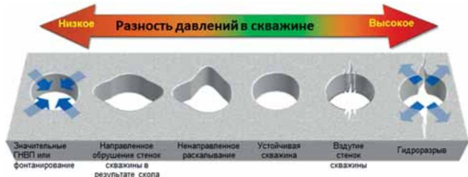
Рис. 1. Примеры осложнений ствола скважины
