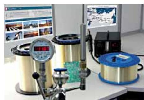
Образец волоконно-оптического точечного датчика давления испытывается в лаборатории компании «ПетроЛайт»
