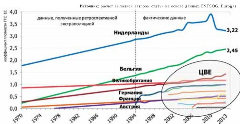
Рис. 2. Плотность газотранспортной системы (магистральные и распределительные газопроводы) в странах Центральной и Восточной Европы, Северо-Западной Европы, км/км<sup>2</sup>
