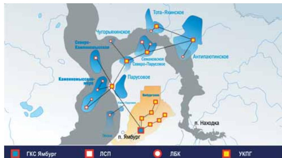
**Рис. 1.** Перспектива освоения месторождений в акватории Обской и Тазовской губ: ГКС — газокомпрессорная станция; ЛСП — ледостойкая платформа; ЛБК — ледостойкий кондуктор; УКПГ — установка комплексной подготовки газа — в 2025 году. Ввод в эксплуатацию (535 млрд м<sup>3</sup>). Техническими ре-
