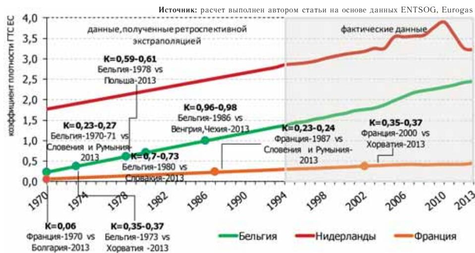
Рис. 3. Сопоставление плотности газотранспортной системы (магистральные и распределительные газопроводы) в странах Центральной и Восточной Европы, Северо-Западной Европы, км/км<sup>2</sup>
