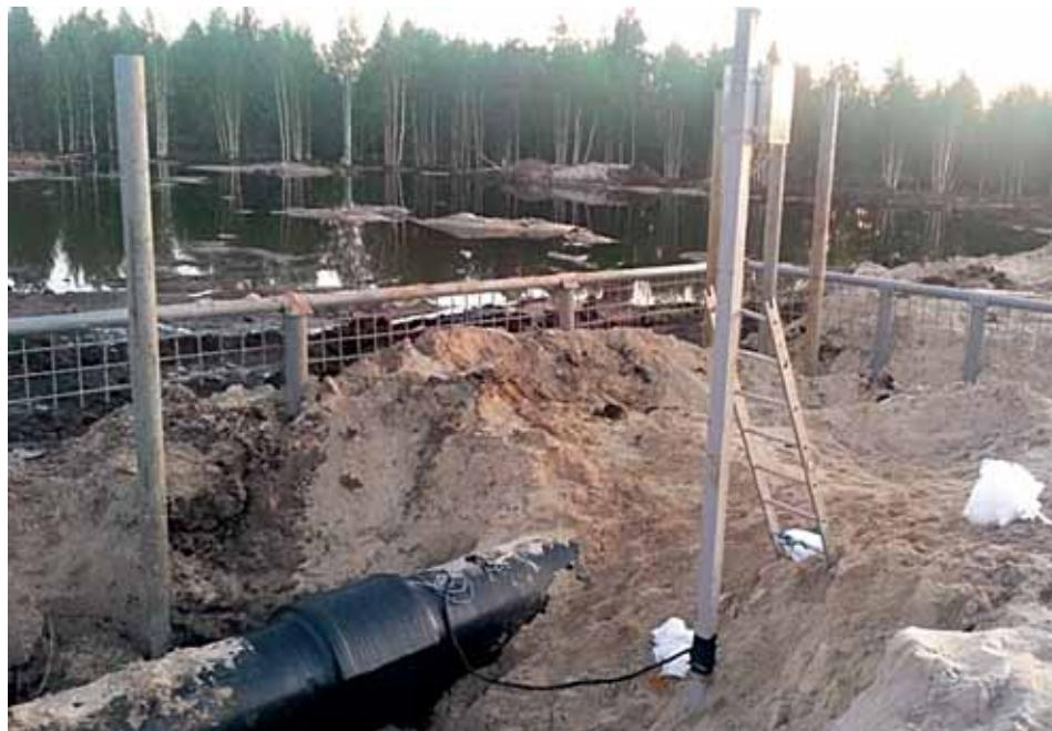
**Фото 1.** Внешний вид изолированной системы УЗ толщинометрии, смонтированной на подземном трубопроводе
