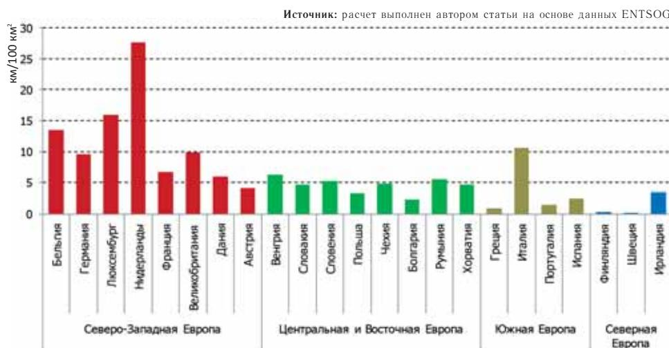
Рис. 1. Плотность газотранспортной системы ЕС (магистральные газопроводы)
