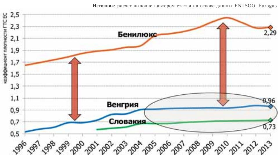
Рис. 5. Сопоставление плотности газотранспортной системы (магистральные и распределительные газопроводы): Бенилюкс (Бельгия, Нидерланды, Люксембург) vs Венгрия и Словакия (Центральная и Восточная Европа), км/км<sup>2</sup>
