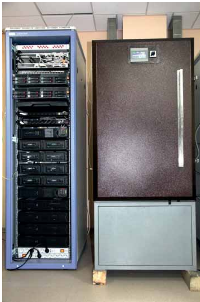
Рис 5. Компоновка ЛМ СМПО «ОптоМониторинг»: А1 — электронный блок, А2 — оптический блок, А3 — релейный блок, А4 — KVM-консоль, А5 — патч-панель, А6 — коммутатор, А7 — оптический кросс, А8 — блок управляемых розеток, А9 — блок электрических розеток, А10 — источник бесперебойного питания А11 — блок аккумуляторных батарей, А12 — блок сигнализатора метана, А13 — блок температурной регистрации, А14 — магнитный размыкатель, А15 — термодатчик
