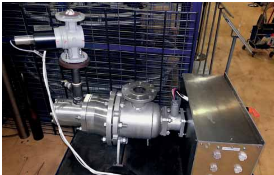
Рис. 3. Опытный образец ДЭА мощностью 1 кВт
