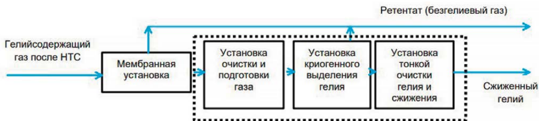
б) принципиальная мембранно-криогенная схема получения товарного гелия
