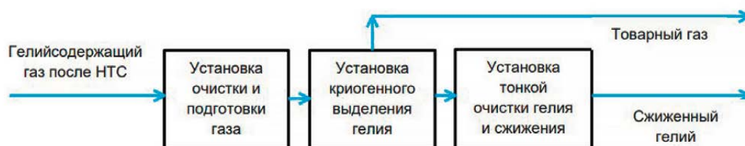
а) принципиальная схема криогенного получения гелия из природного газа
