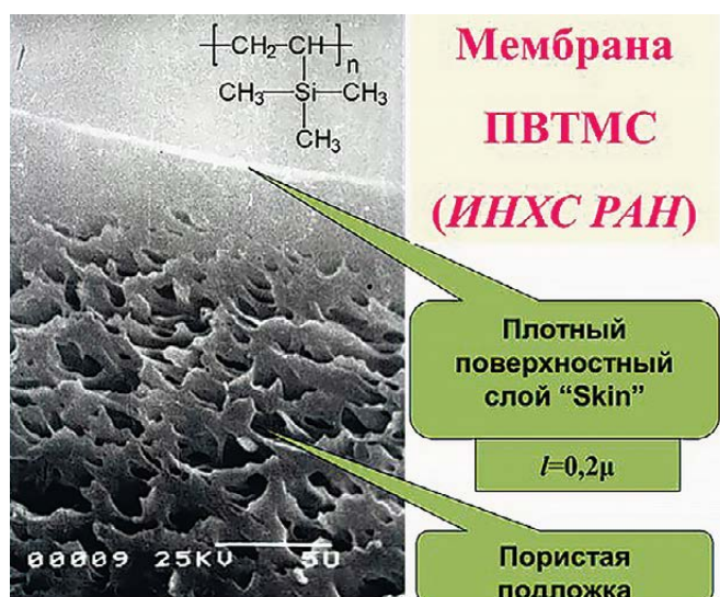
Рисунок 5 – Асимметричная плоская газоразделительная мембрана из ПВТМС
