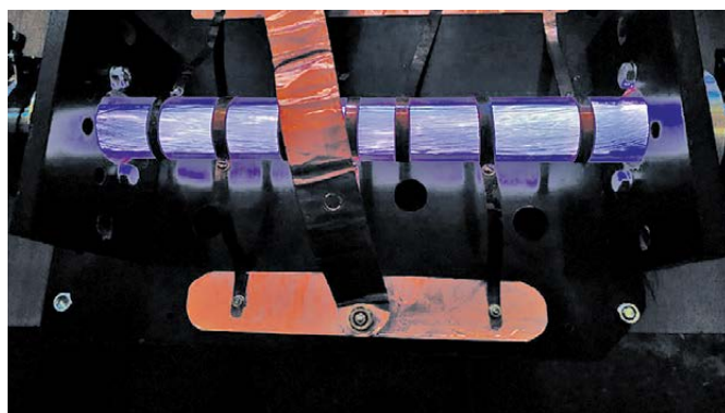
Рисунок 4 – Газовый ВЧ разряд в объеме масштабной модели МЭ с протоком рабочего газа аргона (а) и в замкнутой вакуумной ячейке (б)
