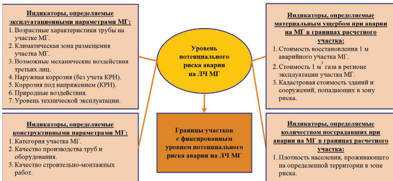
Рисунок 1 – Графическое отображение набора индикаторов, определяющих уровень потенциального риска при аварии на ЛЧ МГ
