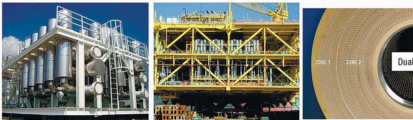
Рисунок 4 – Мембранная установка для извлечения кислых компонентов из ПГ месторождения Чакеравала – терминал Terengganu (адаптировано из [72])
