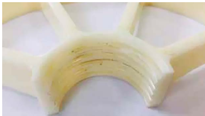
Рисунок 2 – Внешний вид и крепление АД к пермеатотводящей трубке старого (а) и нового образца (б)
