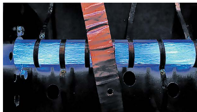
Рисунок 4 – Газовый ВЧ разряд в объеме масштабной модели МЭ с протоком рабочего газа аргона (а) и в замкнутой вакуумной ячейке (б)
