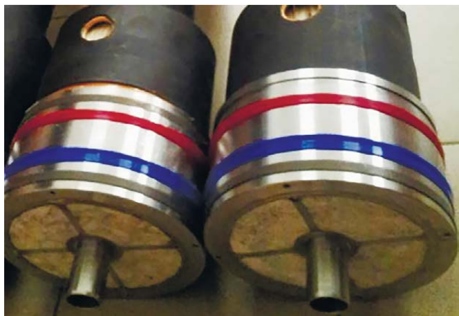
Рисунок 5 – Мембранный модуль для выделения гелия из природного газа
