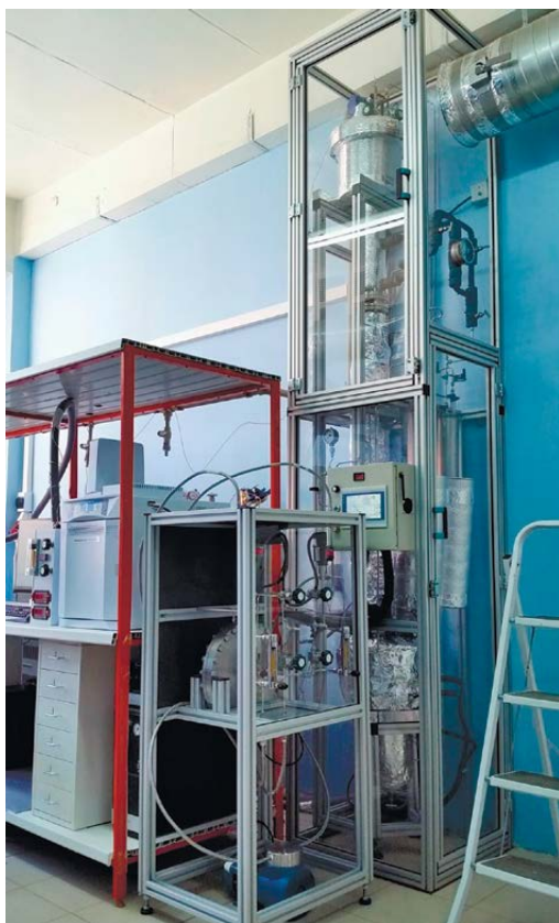
Рисунок 9 – Установка для мембранной дистилляции и схема установки [16]
