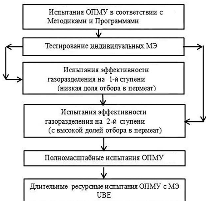
Рисунок 2 – Схема проведения испытаний по выделению гелиевого концентрата на ОПМУ
