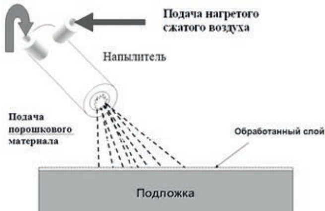
Рис. 2. Схема процесса напыления покрытий методом ХГН
