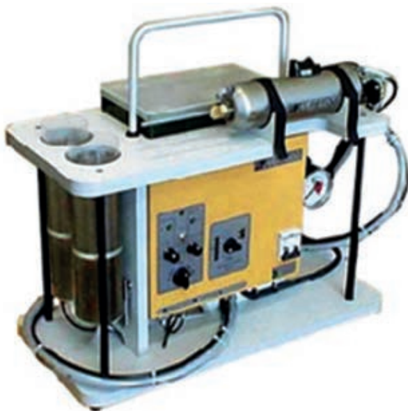
Рис. 3. Полуавтоматическая установка нанесения покрытий методом ХГН: 1 — камера; 2 — манипулятор с образцами; 3 — сверхзвуковое сопло; 4 — порошковый питатель; 5 — компрессор
