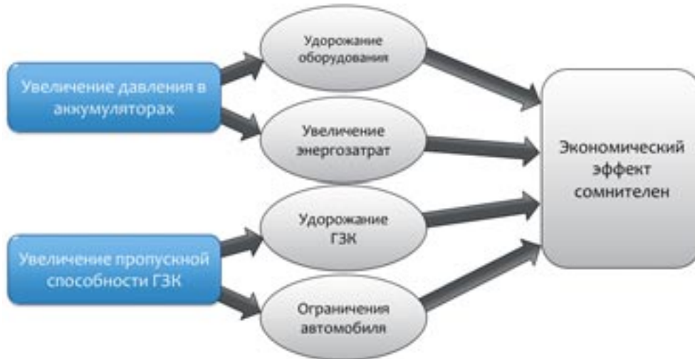
Рис. 2. Способы повышения скорости наполнения баллонов
