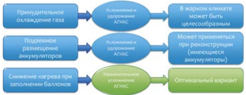
Рис. 4. Способы повышения наполняемости баллонов
