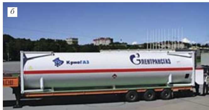
Емкости для хранения газа на судне: а) вкладные цистерны типа С (криогенный топливный танк вместимостью 125 м 3 (Chart Ferroх, Норвегия); б) контейнер-цистерны (контейнер-цистерна КЦМ-35/0,6, ОАО «Уралкриомаш»)
