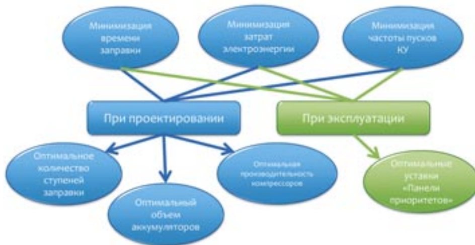
Рис. 8. Оптимизация режима работы АГНКС
