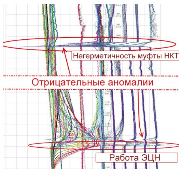
Рис. 5. Попытки запуска ЭЦН. Образование на нем газогидратов
