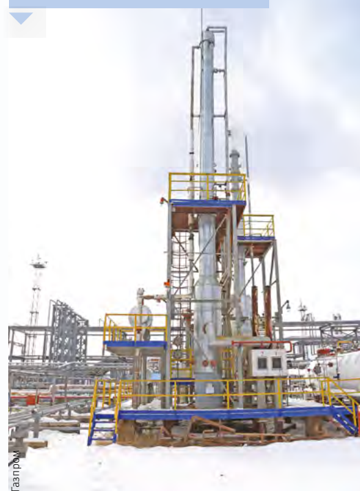
Ковыктинское месторождение. Опытно-промышленная мембранная установка по извлечению гелия
