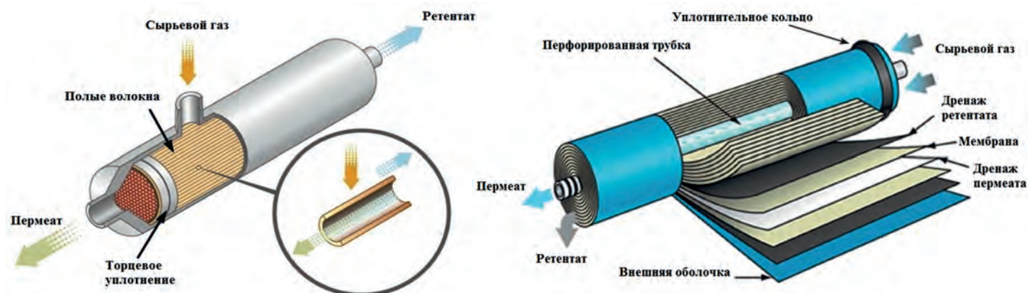
Рис. 4. Конструкция полволоконного (слева) и рулонного (справа) мембранного элемента.
