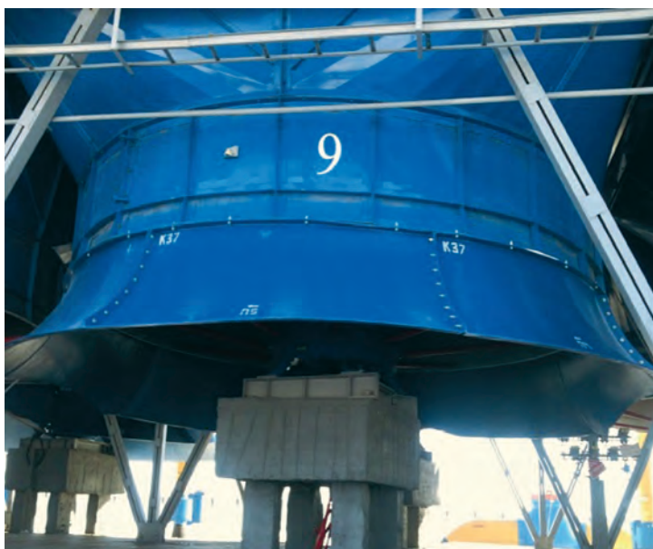
Фото 1. Коллектор плавного входа ГАЦ-50К
